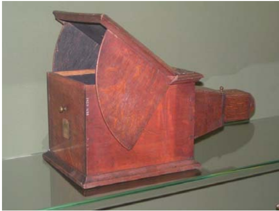
Abbildung 25: Portable Camera obscura mit Linse aus dem Anfang des 19. Jahrhunderts.
