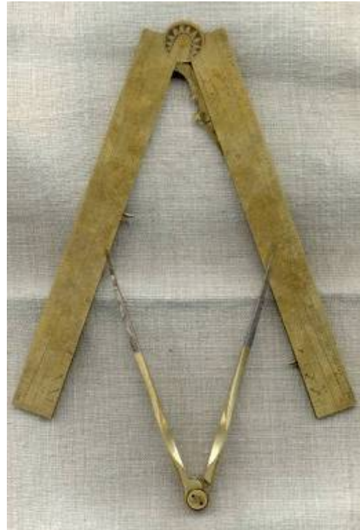
Abbildung 16: Proportionalzirkel für militärische Anwendungen (siehe Text). Hier zusammen mit einem Stechzirkel, um diesen transversim aufzuspannen. (französisch, 18. Jahrhundert).
