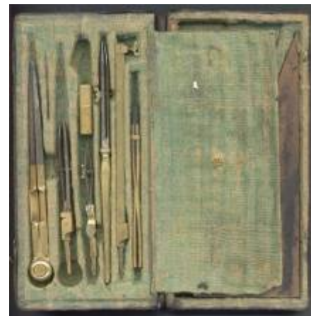
Abbildung 10: Kleines Magazinbesteck, mit grünem Samt ausgeschlagen, von links nach rechts: Stechzirkel, 2 Reißfedern als Einsatz für Stückzirkel, darüber Köcher für Minen, Reißfeder, Verlängerung für Stückzirkel, Porte Crayon mit eingesetzter Kohle. Der Stückzirkel selbst ist verloren gegangen (Brüder Vogtländer, Wien, ca. 1800).
