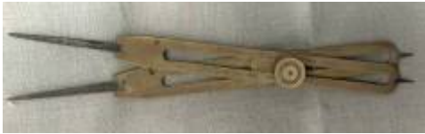
Abbildung 18: Reduktionszirkel, über die Stellschraube in der Mittel lassen sich die Verhältnisse der Schenkel über eine Skala einstellen, hier Flächen = Plains (englisch, ca. 1940)
