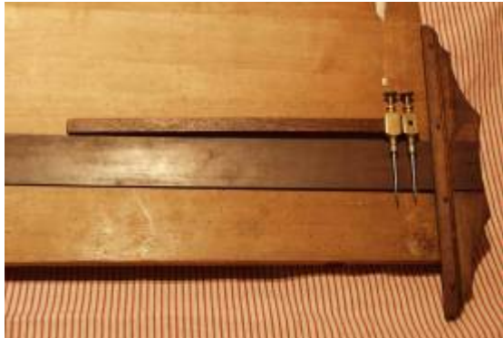
Abbildung 12: Großes Anschlaglineal mit Stangenzirkel auf Zeichenbrett. Stangenzirkel, hier die beiden Spitzen aufgesteckt auf eine ca. 1m lange Hartholzstange, Mahagoni (19. Jahrhundert). Stangenzirkel wurden zum Kopieren von Plänen oder Übertragen genauer Längen für großformatige Pläne oder Karten benutzt.
