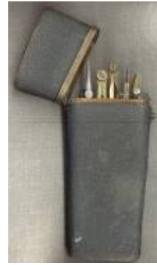
Abbildung 9: Taschenbesteck für den Feldgebrauch, mit Fischhaut bezogen, hier aufgeklappt, so daß Zirkelköpfe und Reißfedern sichtbar sind (englisch, 1. Hälfte 19. Jahrhundert). Das etwas weniger als handgroße Etui kann in der Rocktasche oder auch im Feldkasten transportiert werden.
