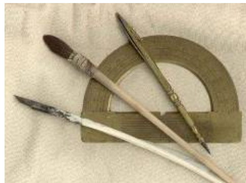
Abbildung 7: Transporteur (s.u.), darauf liegend eine Reißfeder mit Federmesser an der Spitze, ein Tuschpinsel und eine Gänsekielfeder mit dem typischen doppeltgeschwungenem Profil.
