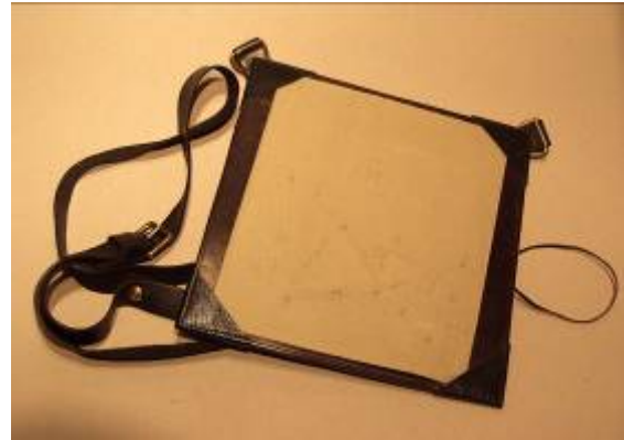
Abbildung 4: Planchet zum Krokieren nach Decker, welches über die Schulter gehängt wird. Darauf ist der Entwurf eines Dreiecksnetzes für die Triangulation zu sehen (Reproduktion des Autors).
