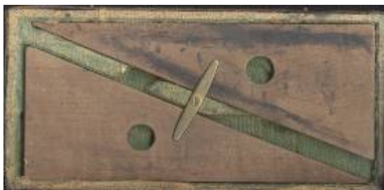
Abbildung 13: Zwei kleinere Dreiecke aus einem Magazinbesteck; sie ersetzen hier das fehlende Parallellineal. (Wien, ca. 1800)
