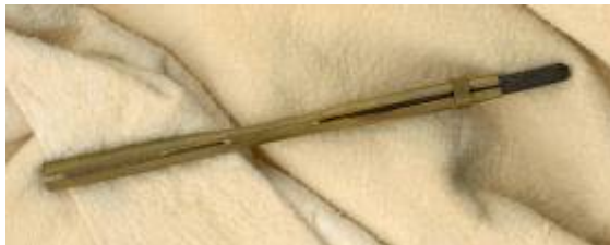
Abbildung 5: Porte Crayon aus einem mathematischen Besteck des 18. Jahrhunderts, hier mit eingespanntem Kohlestück
