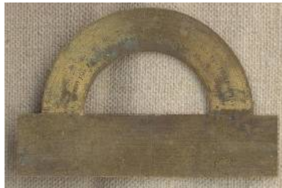
Abbildung 15: Einfacher Transporteur aus Messing mit 180°-Einteilung, je 1/2 Grad genau (Wien, ca. 1800). Eine größere Genauigkeit kann mit einem größeren Halbkreis oder dem Protraktor (siehe folgende Abbildung) erreicht werden.
