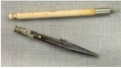
Abbildung 17: Punktier- oder Kopiernadel mit abgeschraubter Reißfeder (wohl englisch, 2. Hälfte des 19. Jahrhunderts)
