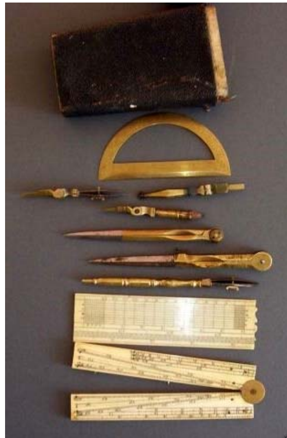
Abbildung 5: Inhalt eines englischen Taschenbestecks: Transporteur, Ziehfeder für Stückzirkel, Koppirrad, Bleistifteinsatz für Stückzirkel, Stechzirkel, Stückzirkel, Ziehfeder, Transversalmaßstab, Proportionalzirkel für einfache Überschlagsrechnungen (England, ca. 1800)
